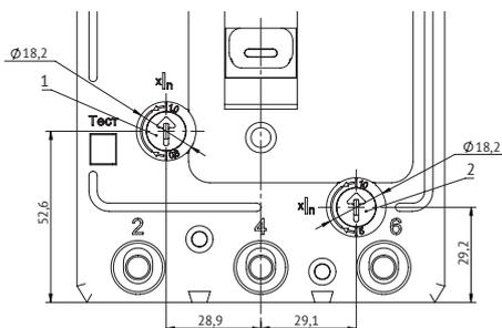
Выключатель с регулируемыми максимальными расцепителями.
