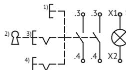
Выключатели/переключатели с одним замыкающим и размыкающим контактами
