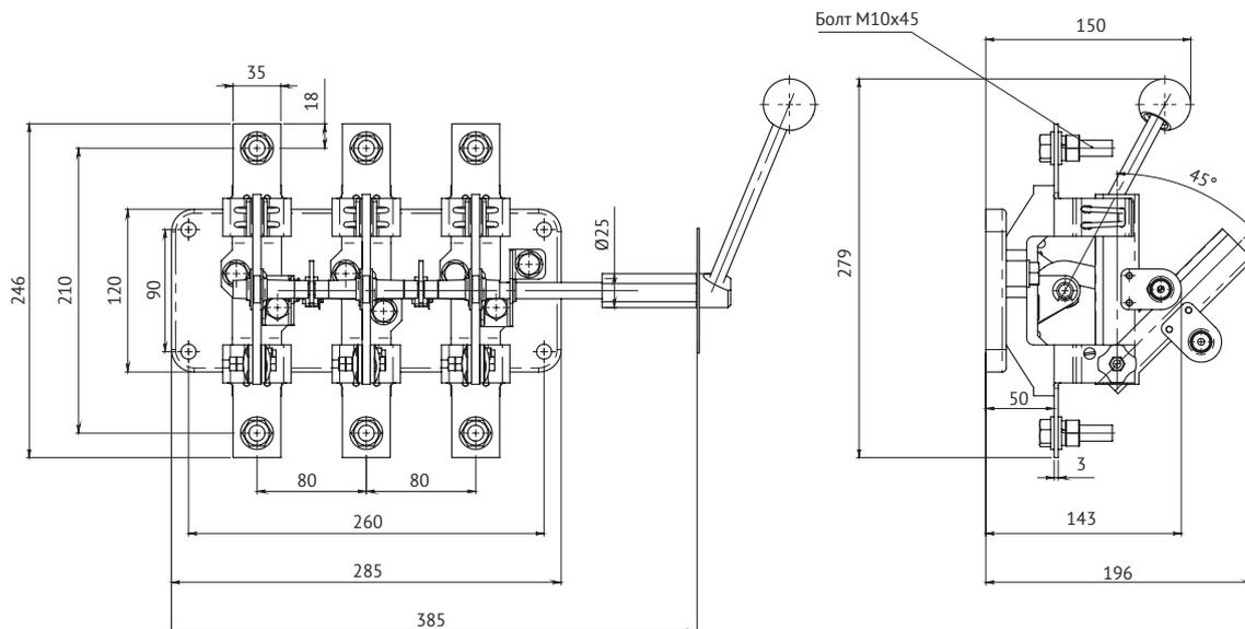
Разъединитель серии Р с центральным приводом РЦ-1, на номинальный ток 100 А
