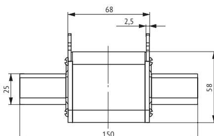
Плавкая вставка предохранителя
