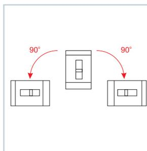
Широкие возможности по компоновке щитов за счет монтажа устройств как вертикально, так и повернув вправо/влево на 90°.
