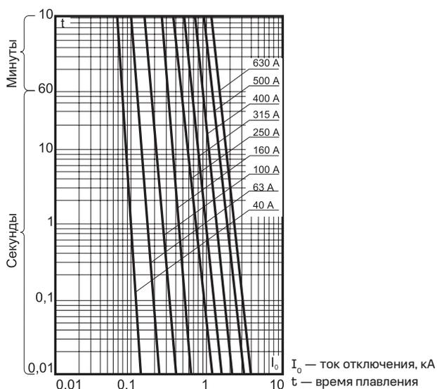
Предохранители типа ПНБ5-380/250, ПНБ5-1250/630
