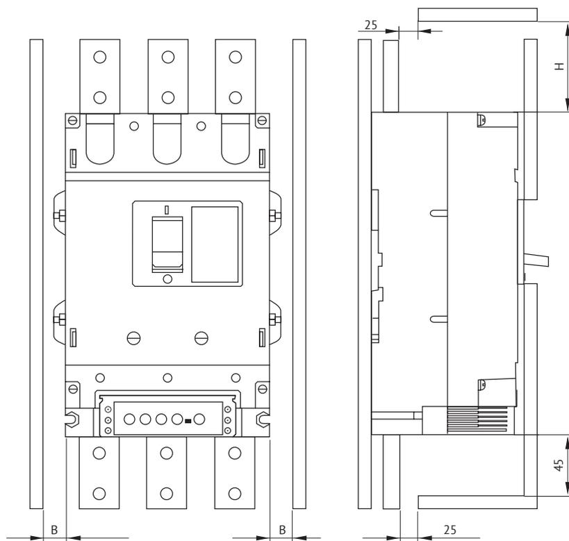
Автоматические выключатели ВА52-41, ВА53-41, ВА55-41, ВА56-41 с электромагнитным приводом
