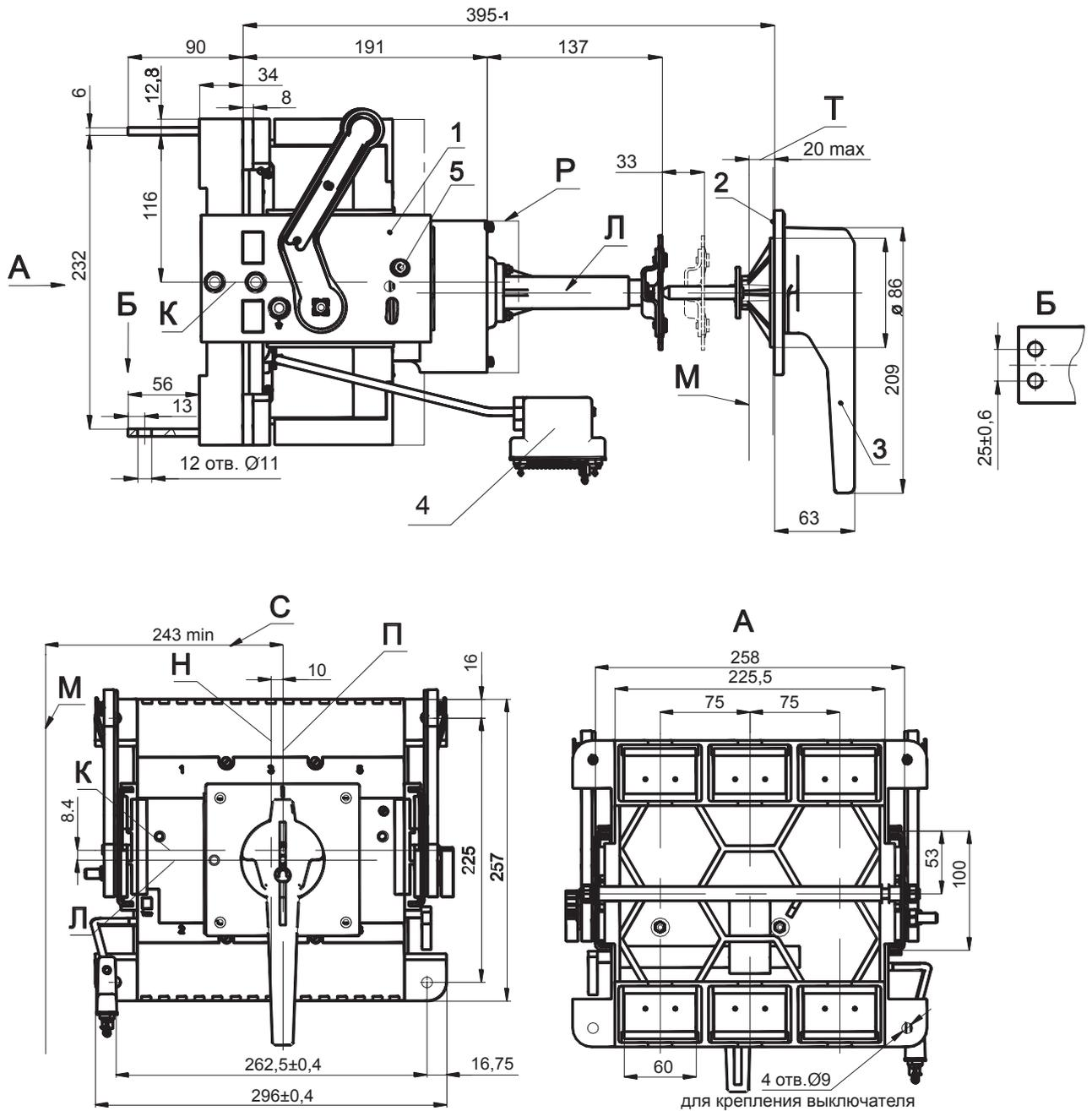
Автоматический выключатель ВА57-39 выдвигного исполнения с электромагнитным приводом
