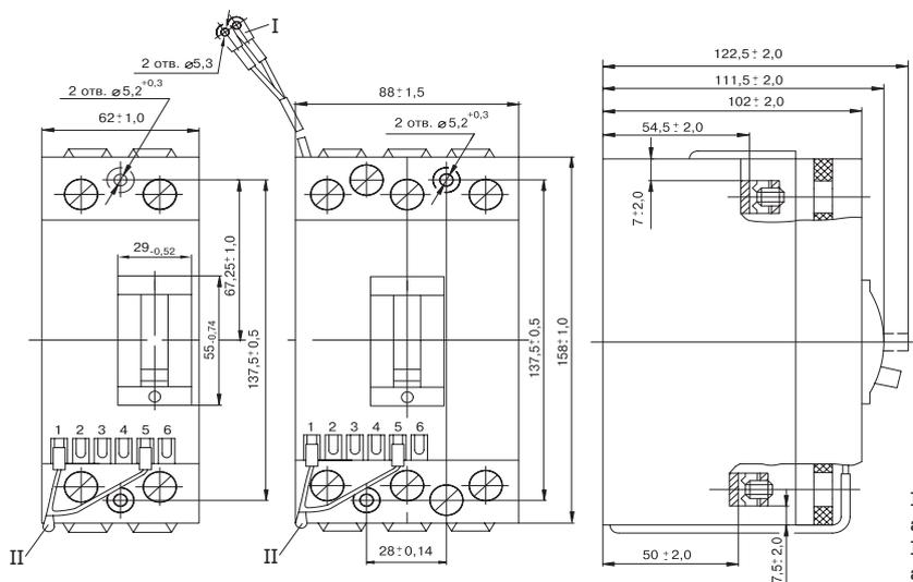
I — выводы катушки независимого расцепителя автоматических выключателей ВА13-25 и ВА13-29XX12
