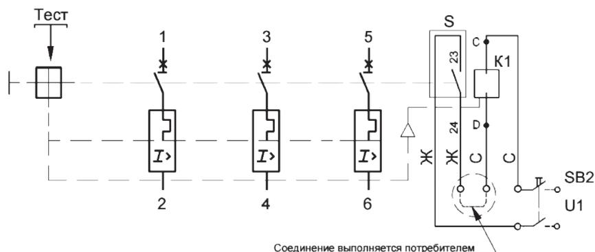
**Автоматические выключатели ВА51-39-ХХ5610 (16) с нулевым или минимальным расцепителем напряжения, вспомогательными контактами сигнализации автоматического отключения и вспомогательными контактами**
