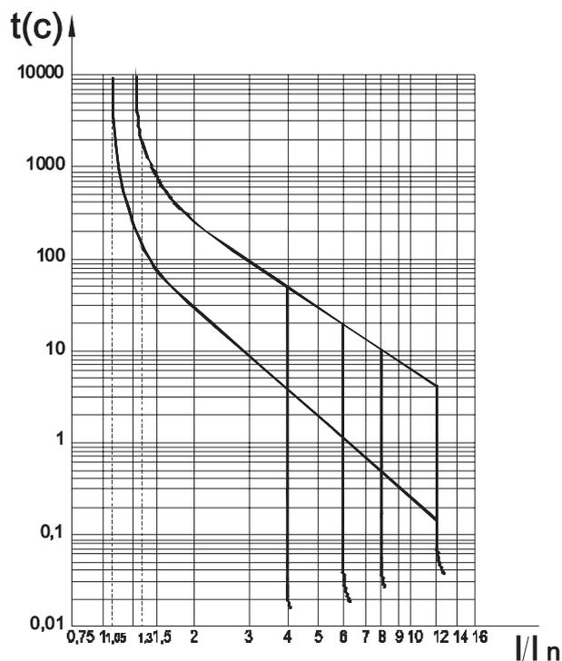
Автоматические выключатели с электромагнитными и тепловыми расцепителями с уставкой по току срабатывания  $5 I_n$ ,  $10 I_n$  при температуре  $30^\circ\text{C}$ .
