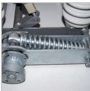
Вид привода: пружинный, взводимый вручную или электроприводом.
