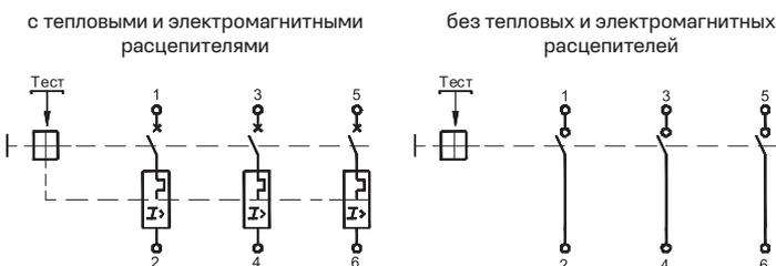
**Схема электрическая принципиальная автоматического выключателя ВА51-XX-XX1210 (16) переменного тока трехполюсного исполнения с независимым расцепителем (без свободных вспомогательных контактов)**
