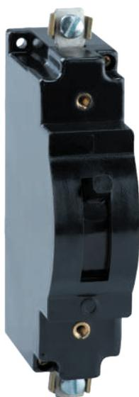
Однополюсные автоматические выключатели серии А63 предназначены для проведения тока в нормальном режиме и отключении защищаемых электрических сетей и электрооборудования при токах коротких замыканий и перегрузок, а также для оперативных включений и отключений электрических цепей до 30 раз в сутки.
