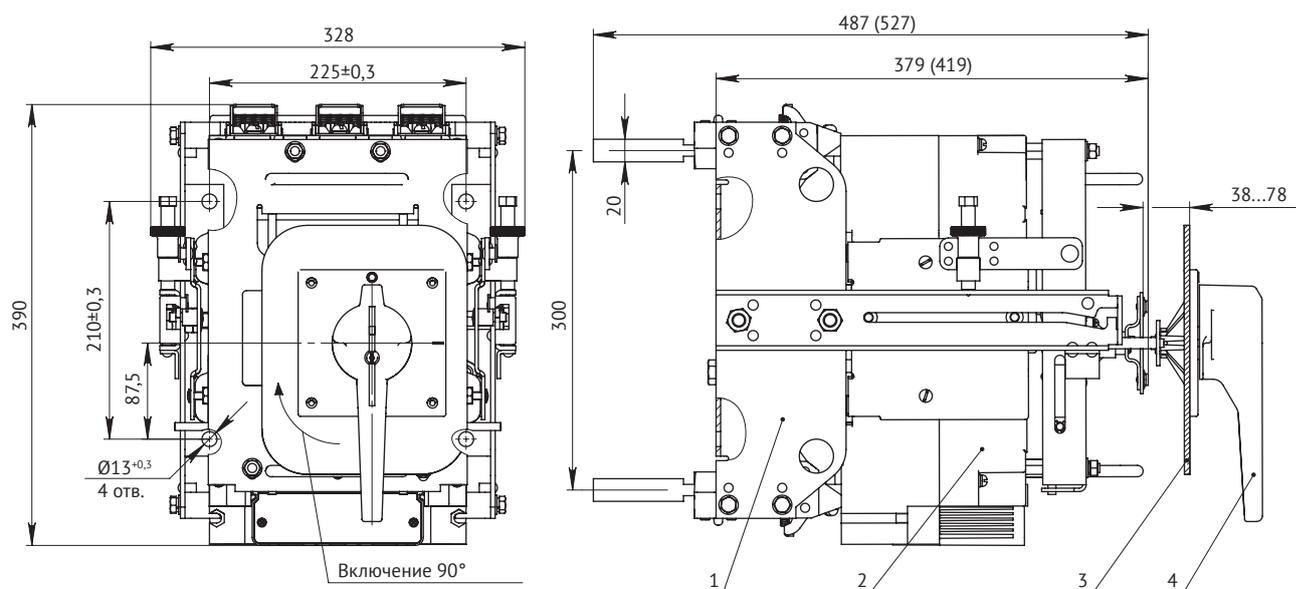
1 — каркас; 2 — автоматический выключатель;
