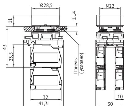
КМЕ 42...м (с цилиндрическим толкателем с самовозвратом и защитным колпачком на пластиковом основании)
