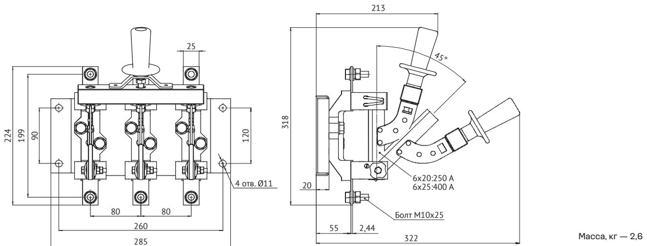
**Разъединитель PE19-35(37)-31190-250A(400A)-УХЛЗ трехполюсный с центральным рычагом для управления штангой, переднего присоединения шин**
