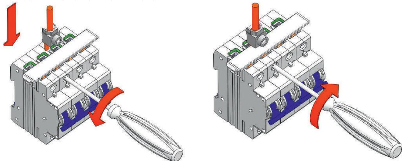
\* При подключении модульных аппаратов серии OptiDin с возможностью подключения питания шиной тип FORK монтаж клеммы осуществляется в основную клеммную колодку модульного аппарата.
