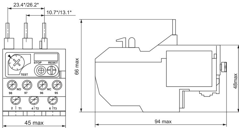
Реле типа РТЛ-1000 для подсоединения к контактору
