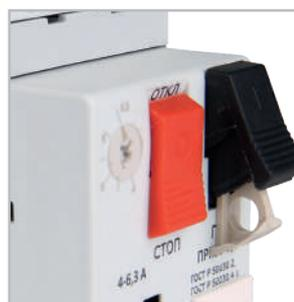
Предотвращение несанкционированного включения пускателей ПРК с помощью применения замков с диаметром дужки до 5 мм.
