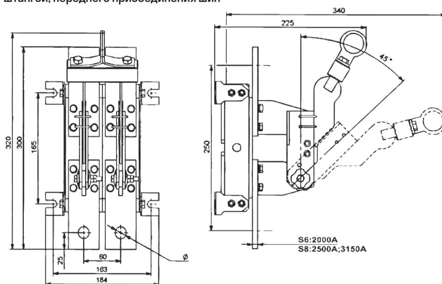
Разъединитель РЕ19-44(45,46)-12210-2000А(2500А, 3150А)-УХЛЗ однополюсный с центральной рукояткой, заднего присоединения шин
