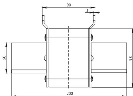
Плавкая вставка предохранителя
