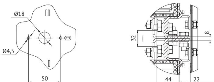
**Выключатель-разъединитель ВНК-37-31130 УХЛ3 на одно направление**
