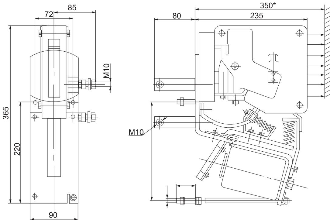
\* - Расстояние от вертикальной установочной плоскости с учетом вылета дуги за пределы дугогасительной камеры
