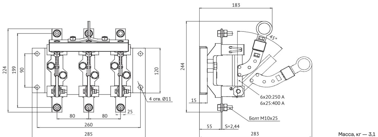
**Разъединитель PE19-35(37)-31170-250A(400A)-УХЛЗ трехполюсный с рукояткой для пополюсного оперирования, переднего присоединения шин**
