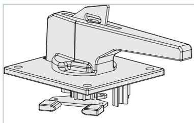
Ручной дистанционный привод (РДП) с запирающим устройством в положении «Отключено». Ручной дистанционный привод закрепляется на двери распределительного устройства. Его рукоятка через поводок кинематически связана с ручкой автоматического выключателя, что позволяет оперировать автоматическим выключателем при закрытой двери распределительного устройства. Поставляется отдельно.
