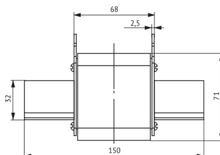
Плавкая вставка предохранителя
