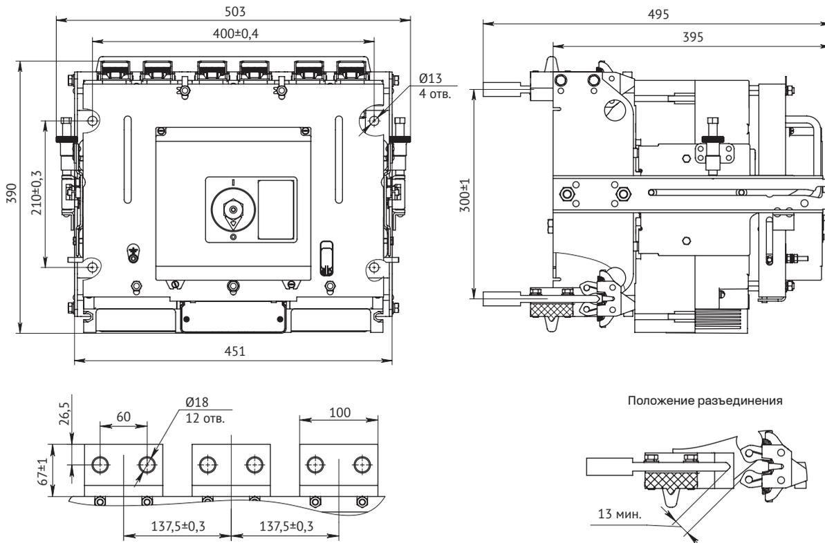
**Выдвижное исполнение автоматических выключателей ВА53-43, ВА55-43, ВА56-43 с ручным дистанционным приводом для управления через дверь НКУ на номинальный ток 1600 А**
