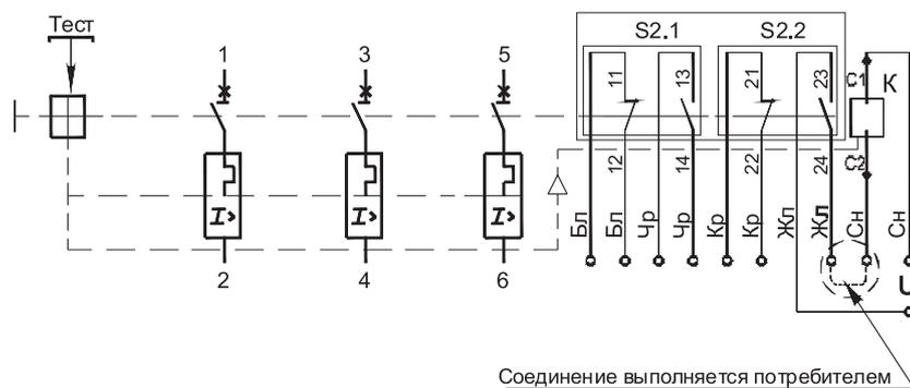
Схема электрическая принципиальная автоматического выключателя ВА04-36-XX1110 (16) переменного тока трехполюсного исполнения со вспомогательными контактами (без независимого расцепителя)
