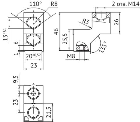
**Способы присоединения проводников к выводам автоматического выключателя (1, 3, 5 или 2, 4, 6) ВА51-39**
