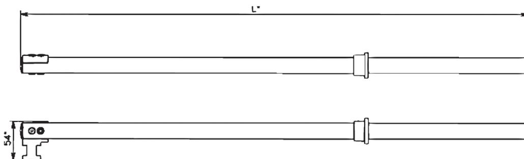
\*L может быть: 706 мм; 1041 мм; 1241 мм; 1541 мм; 2041 мм.
