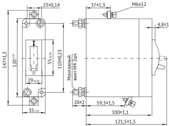
Однополюсный автоматический выключатель ВА21 в трехполюсном габарите
