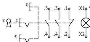
Выключатели/переключатели с одним замыкающим и двумя размыкающими контактами
