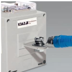
В модификации ТТК-А возможно подключение как медных, так и алюминиевых проводников, для осуществления монтажа комплектуется винтами и гайками для крепления шины.
