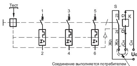
Схема электрическая принципиальная автоматического выключателя ВА51-XX-XX1810 (16) переменного тока трехполюсного исполнения с независимым расцепителем и вспомогательными контактами
