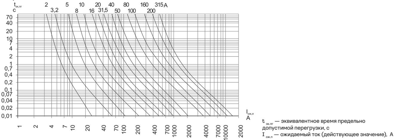
**Время - токовые характеристики плавления предохранителей на номинальные токи 2-160 А, номинальное напряжение 10 кВ**
