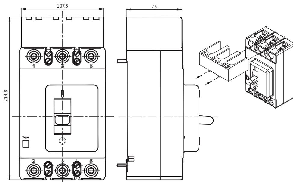
Автоматические выключатели с ручным дистанционным приводом для оперирования через дверь распределительного устройства
