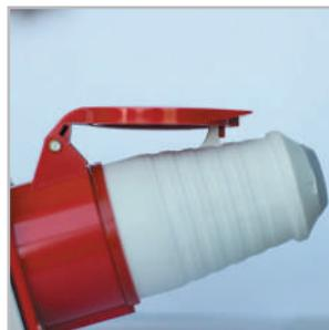
Пластмассовый шип на корпусе силового разъема позволяет фиксировать крышку ответной части соединения и предотвратить возможное несанкционированное отключение при механическом воздействии на присоединенный кабель вследствие его натяжения.
