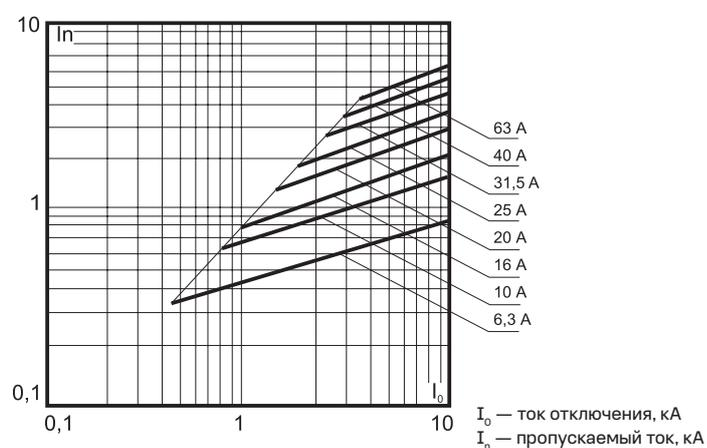
Время-токовые характеристики отключения при напряжении 220 В постоянного тока
