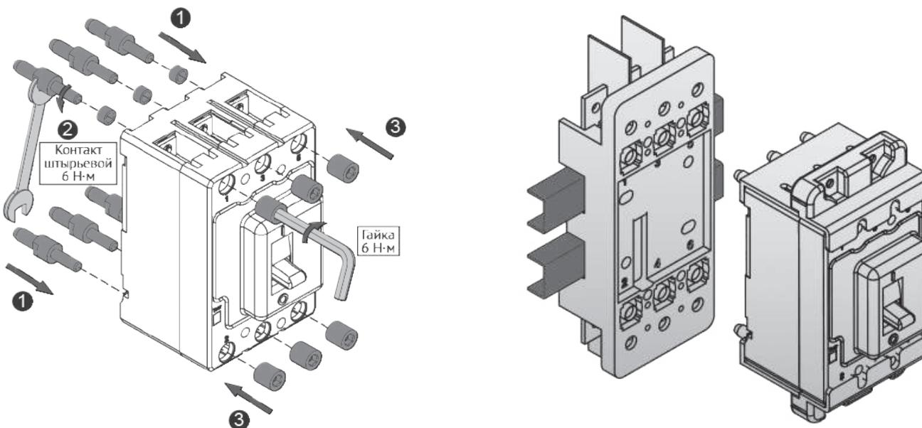
В «Панель втычную ВА57-35-УХЛ3 – КЭАЗ (на токи 63 ÷ 250 А)» входят комплекты монтажных частей 1, 2 и 3.
