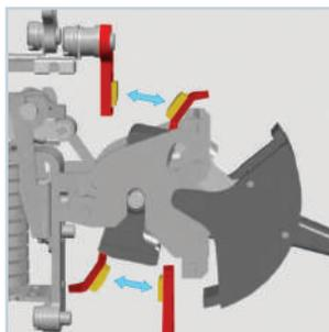
Контактная система «мостикового» типа.
