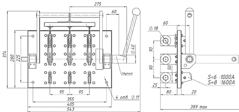
**Разъединитель PE19-41(43)-72250-1000A(1600A)-ИП-УХЛЗ на два направления с боковой смещенной рукояткой, заднего присоединения шин на изоляционной плите**
