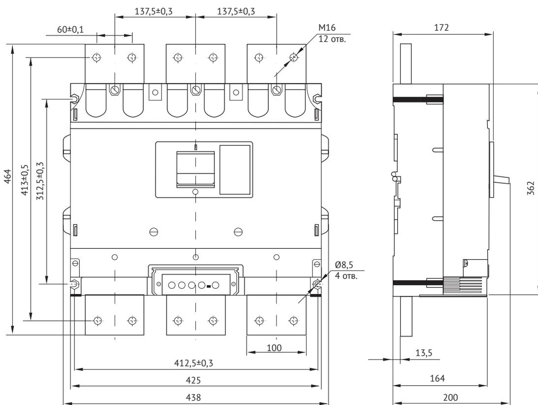
ВА53-43, ВА55-43, ВА56-43 с электромагнитным дистанционным приводом на номинальный ток 1600 А
