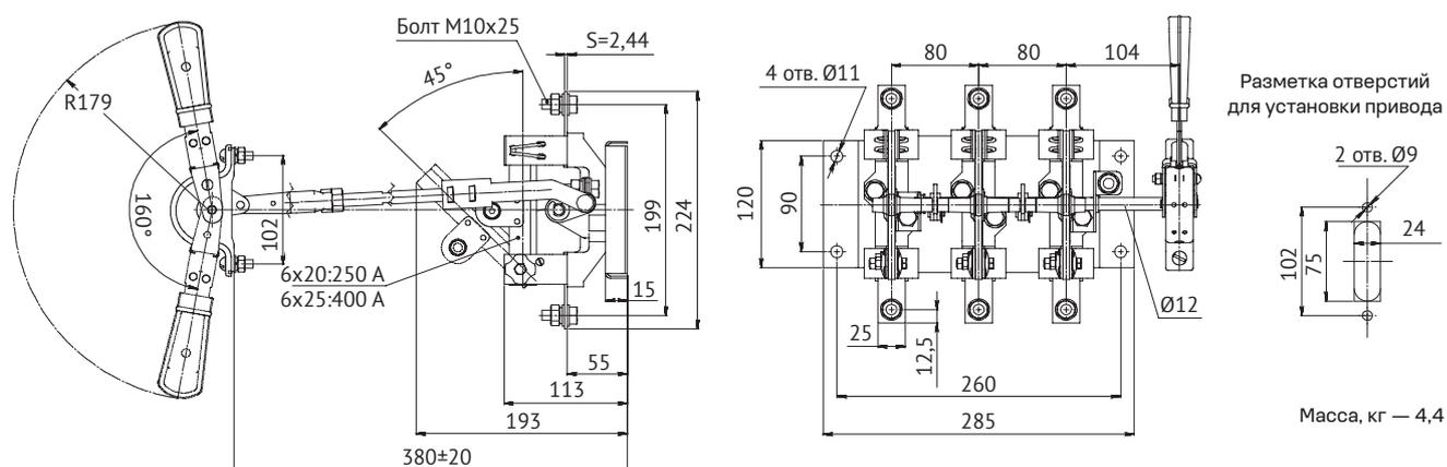
**Разъединитель PE19-39-31190-630A-УХЛ3 трехполюсный с центральным рычагом для управления штангой, переднего присоединения шин**
