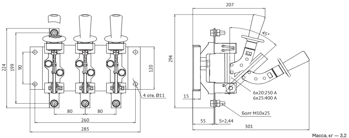
**Разъединитель РЕ19-35(37)-31160-250А(400А)-УХЛЗ трехполюсный с рычагом для пополюсного оперирования штангой, переднего присоединения шин**
