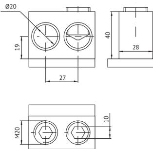
**Зажим для переднего присоединения четырех кабелей сечением до 120 мм<sup>2</sup>**
