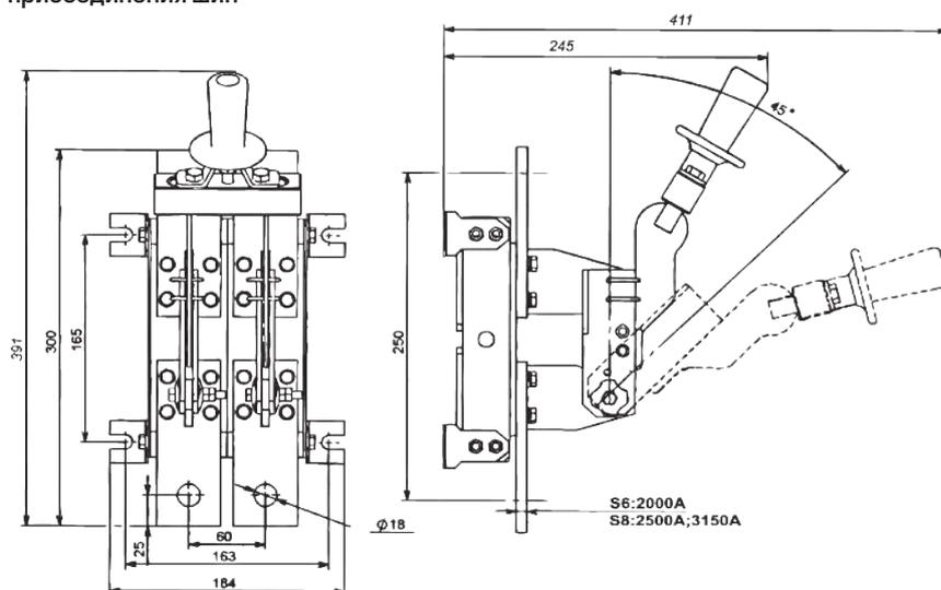
Разъединитель РЕ19-44(45,46)-11190-2000А(2500А, 3150А)-УХЛЗ однополюсный с центральным рычагом для управления штангой, переднего присоединения шин
