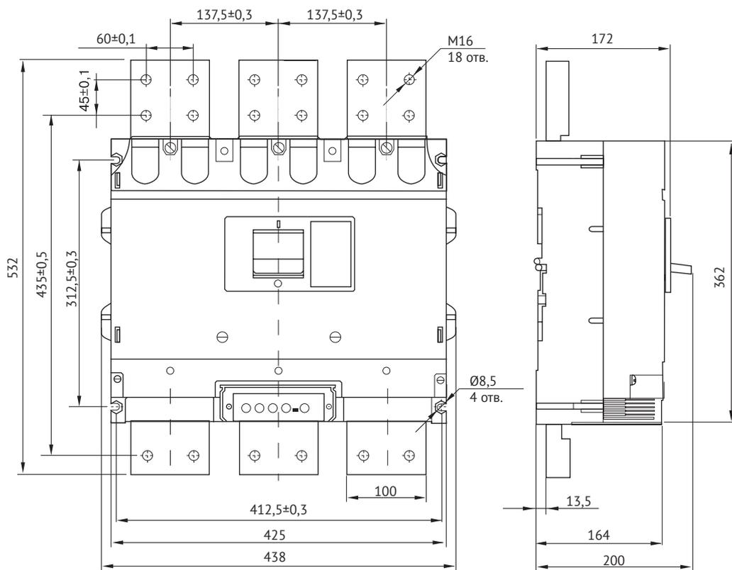
**ВА53-43, ВА55-43, ВА56-43 с электромагнитным дистанционным приводом на номинальный ток 2000 А**
