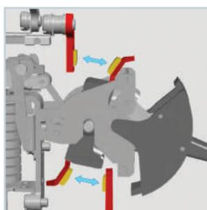
Контактная система «мостикового» типа.
