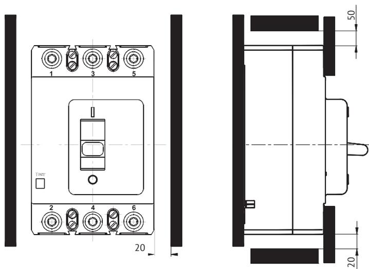
Расположение отверстий для крепления ручного дистанционного привода
