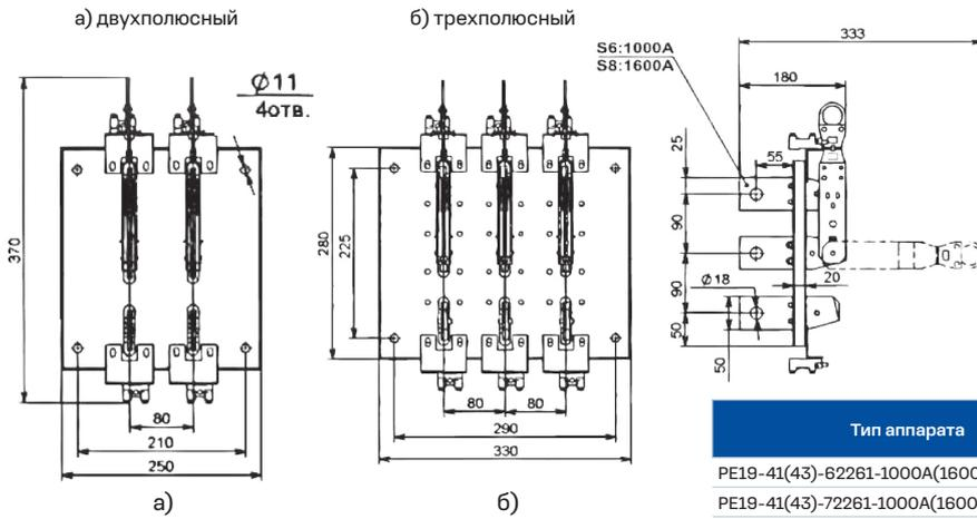
**Разъединитель PE19-41(43)-72220-1000A(1600A)-ИП-УХЛЗ на два направления с боковой рукояткой, заднего присоединения шин на изоляционной плите**
