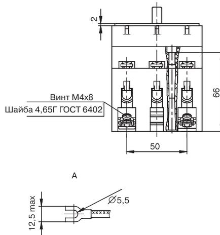
Автоматические выключатели типов AE2046M, AE2043M со вспомогательными контактами
