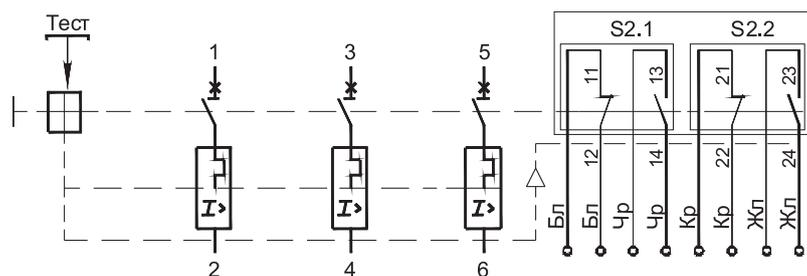
**Схема электрическая принципиальная автоматических выключателей ВА04-36-ХХ1830 с электромагнитным приводом, с независимым расцепителем и вспомогательными контактами**
