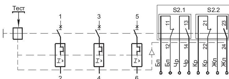
Схема электрическая принципиальная автоматических выключателей ВА51-XX-XX1830 с электромагнитным приводом, с независимым расцепителем и вспомогательными контактами
