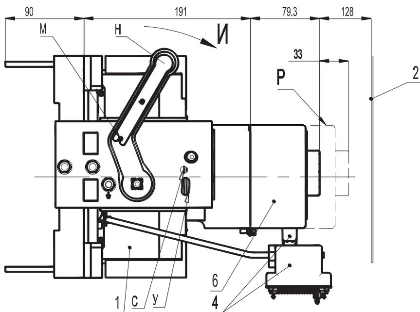
Автоматический выключатель ВА57-39 выдвигного исполнения с ручным приводом
