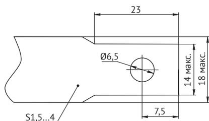
Адаптер для крепления автоматического выключателя AE2040M на 35 мм DIN-рейку
