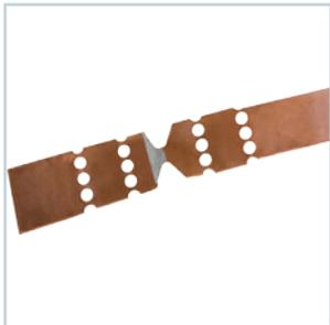
Плавкие элементы выполнены из электротехнической меди с нанесением напайки из олова, что позволяет обеспечить защиту от коротких замыканий и перегрузок.
