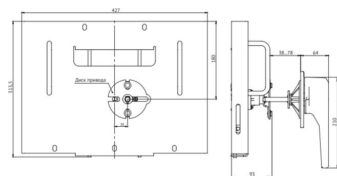
Габаритные размеры ручного дистанционного привода
