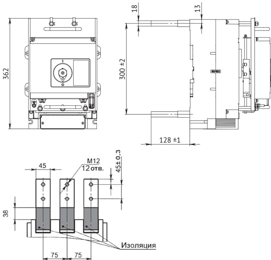
Выдвижное исполнение автоматических выключателей ВА52-41, ВА53-41, ВА55-41, ВА56-41 с электромагнитным дистанционным приводом на номинальные токи 250 А, 400 А, 630 А, 1000 А
