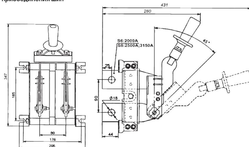
Разъединитель PE19-44(45,46)-12290-2000A(2500A, 3150A)-УХЛЗ однополюсный с центральным рычагом для управления штангой, заднего присоединения шин
