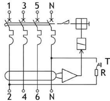
T — устройство эксплуатационного контроля (кнопка ТЕСТ)
