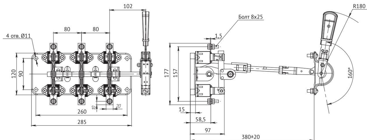
Разъединитель серии Р с передней смещенной рукояткой РС-2, РС-4, РС-6 на номинальный ток 250 А, 400 А и 630 А
