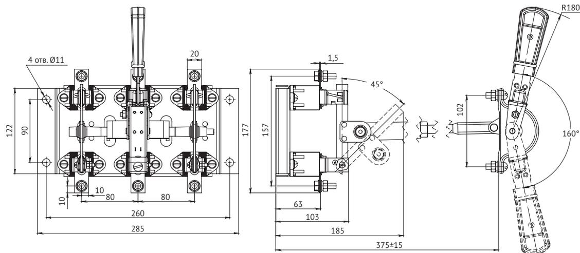
Разъединитель серии Р с центральным приводом, РЦ-2, РЦ-4 на номинальный ток 250 и 400 А
