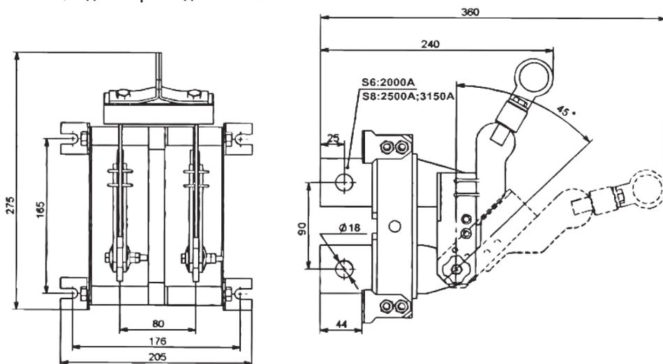
Разъединитель PE19 с рычагом для пополюсного оперирования штангой переднего присоединения шин на изоляционной плите
