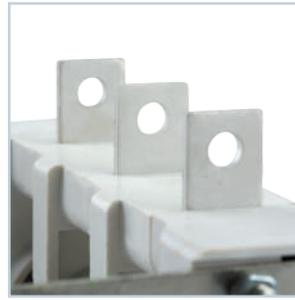
Контактные выводы, выполненные из высококачественной электро-технической меди (ВР32Ф-100А из биметалла) с нанесенным защитным покрытием, позволяют присоединять медные и алюминиевые токопроводящие жилы, оконцованные кабельными наконечниками, а также медные и алюминиевые шины.
