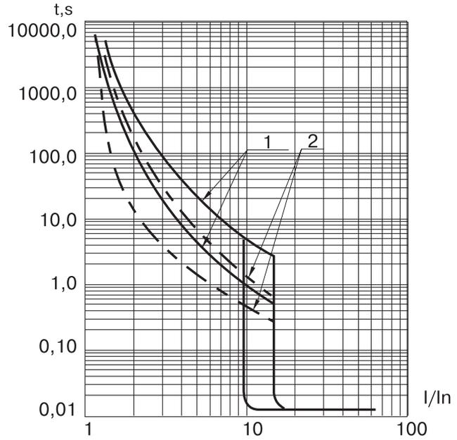
1 — зона работы теплового максимального расцепителя тока, снятая с холодного состояния
