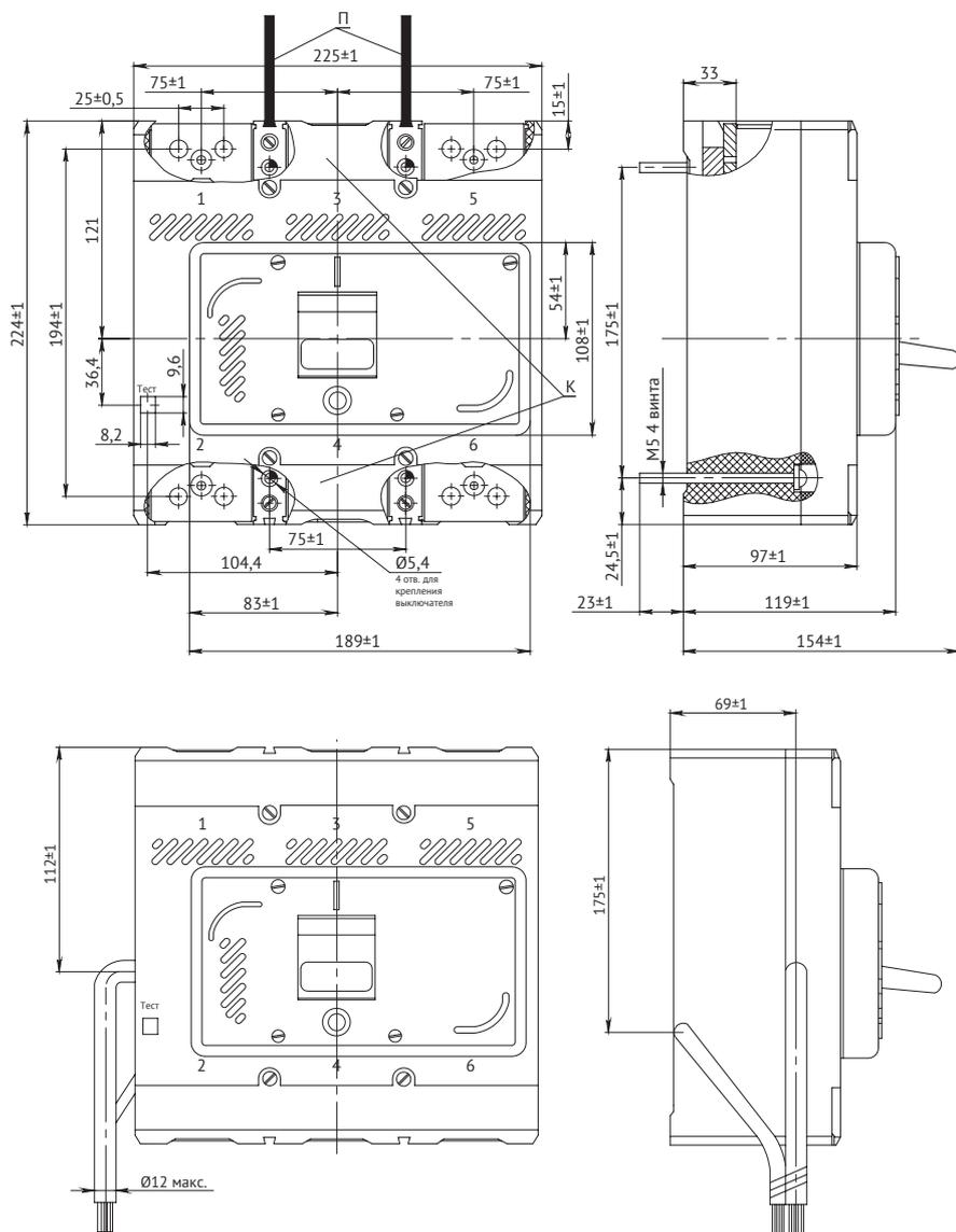
Стационарного исполнения с электромагнитным приводом
