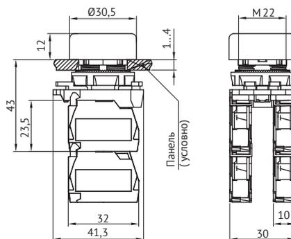
КМЕ...42МС (с цилиндрическим толкателем с самовозвратом и защитным колпачком на стальном основании)
