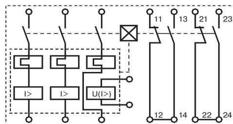
с минимальным расцепителем напряжения или максимальным расцепителем в нулевом проводе
