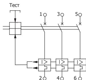
Автоматические выключатели переменного тока трехполюсного исполнения с независимым расцепителем и вспомогательными контактами (кроме BA57Ф35)
