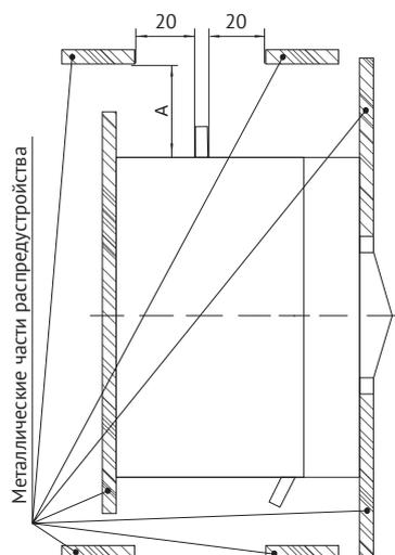
Минимально допустимые расстояния до металлических частей необходимо выбирать исходя из значения номинального напряжения автоматического выключателя.
