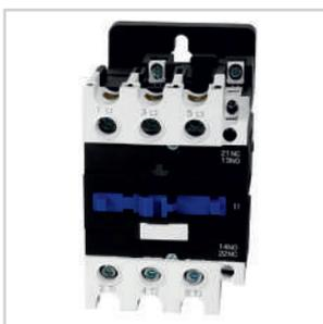
Наличие встроенных дополнительных контактов. Каждый контактор до 32 А комплектуется одним встроенным дополнительным контактом: 1з или 1р (закрывающий или размыкающий). Контактors от 40 до 95 А комплектуется двумя дополнительными контактами: 1з + 1р.
