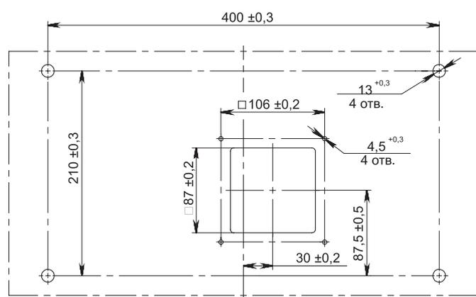
Выполнение отверстий для установки рукоятки на двери НКУ относительно контура привода.
