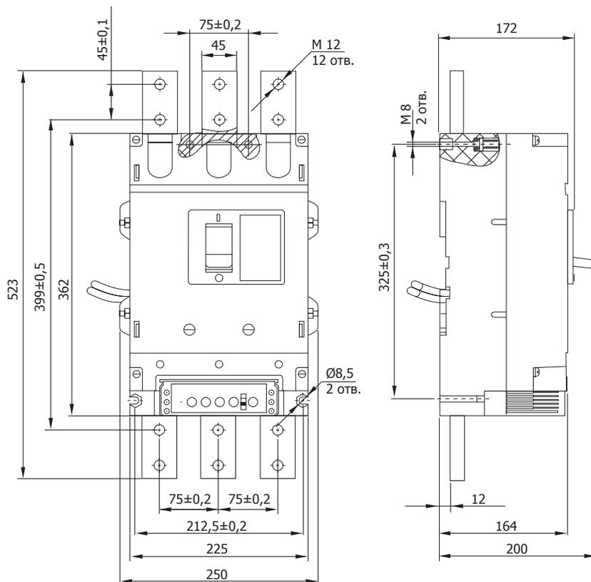
ВА52-41, ВА53-41, ВА55-41, ВА56-41 с электромагнитным дистанционным приводом на номинальные токи 250 А, 400 А, 630 А, 1000 А
