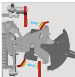
Контактная система «мостикового» типа.
