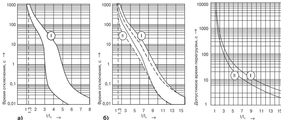
С электромагнитными расцепителями с гидравлическим замедлением с уставкой  $6 I_n$  — постоянный ток (а), с уставкой  $12 I_n$  — переменный ток (б).
