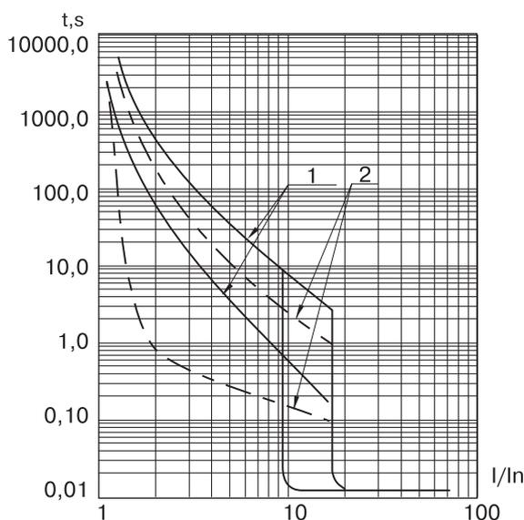
1 — зона работы теплового максимального расцепителя тока, снятая с холодного состояния
