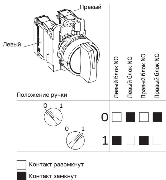
Рабочие положения контактных блоков 3-х позиционного переключателя
