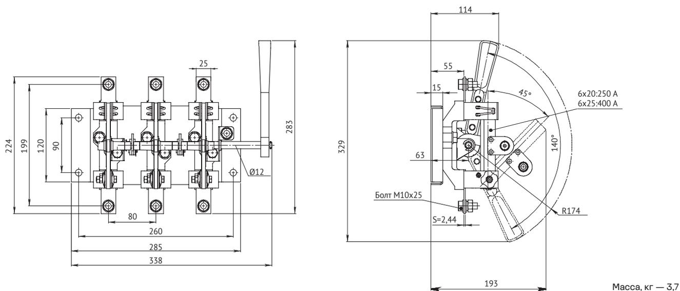
**Разъединитель РЕ19-35(37)-31140-250А(400А)-УХЛЗ трехполюсный с передней смещенной рукояткой, переднего присоединения шин**
