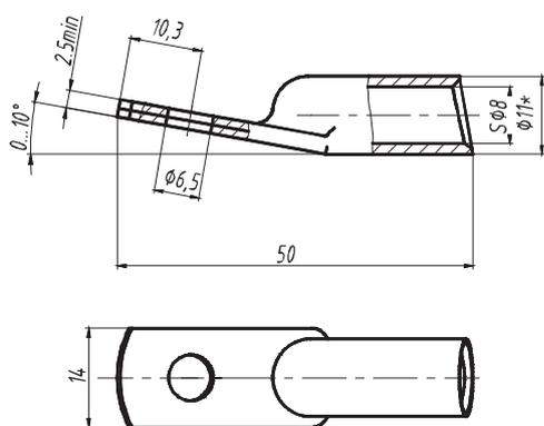
Форма и размеры присоединяемой шины
