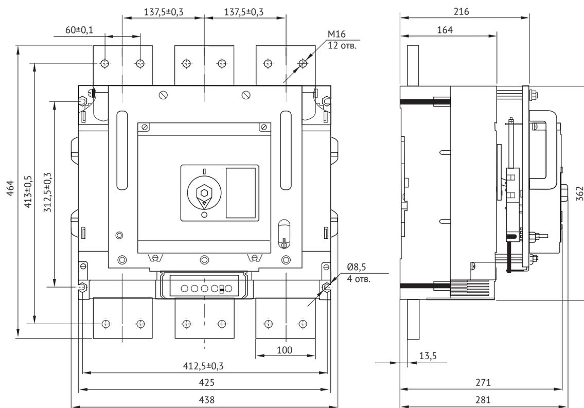
**Выдвижное исполнение автоматических выключателей ВА53-43, ВА55-43, ВА56-43 с электромагнитным дистанционным приводом на номинальный ток 1600 А**
