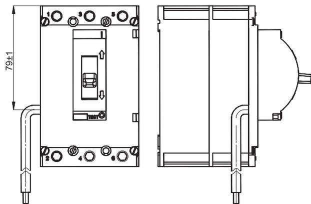
С автоматическим выключателем ВА57-31 комплектно поставляется клеммная крышка, устанавливаемая со стороны выводов 1, 3, 5. Клеммные крышки можно заказать отдельно.
