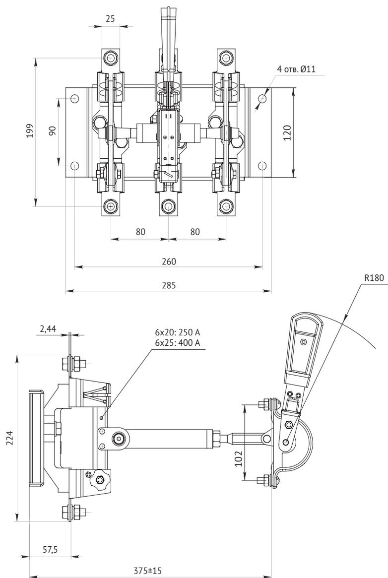
Разъединитель серии Р с центральным приводом, РЦ-6 на номинальный ток 630 А
