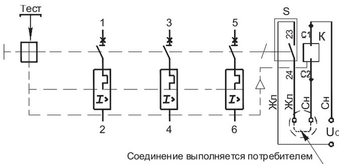
Схема электрическая принципиальная автоматического выключателя ВА04-36-XX1810 (16) переменного тока трехполюсного исполнения с независимым расцепителем и вспомогательными контактами
