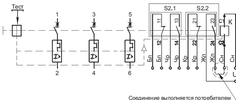
Схема электрическая принципиальная автоматического выключателя ВА51-XX-XX1110 (16) переменного тока трехполюсного исполнения со вспомогательными контактами (без независимого расцепителя)
