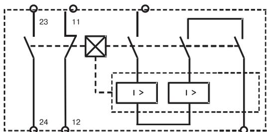
Трехполюсный автоматический выключатель с 2 размыкающими и 2 замыкающими контактами
