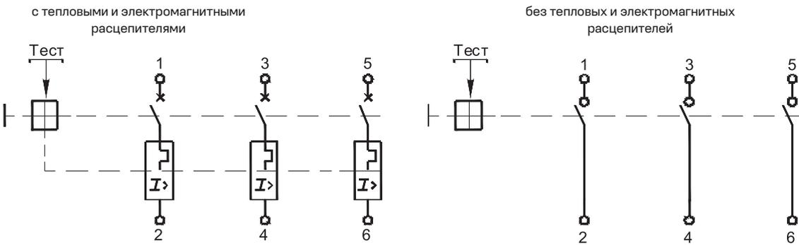
Схема электрическая принципиальная автоматического выключателя ВА04-36-XX1210 (16) переменного тока трехполюсного исполнения с независимым расцепителем (без свободных вспомогательных контактов)
