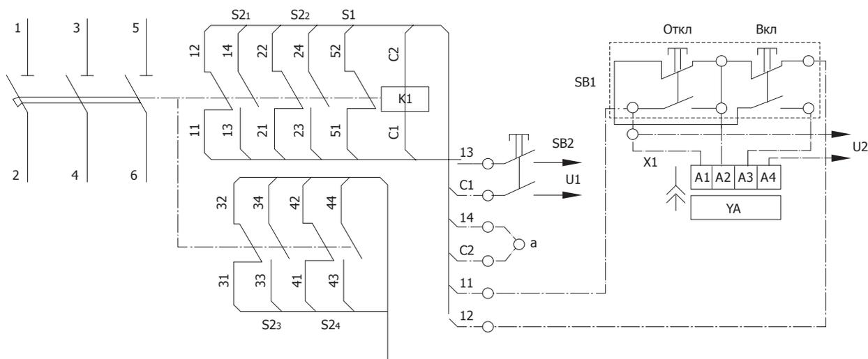
Схема сигнального контакта S1 приведена для выключателя в коммутационном положении «Отключено автоматически».
