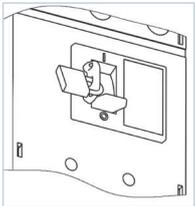
Устройство запираания предназначено для фиксирования ручки переключения автоматического выключателя в положении «Отключено» с целью обеспечения безопасности людей при ремонте и обслуживании оборудования.
