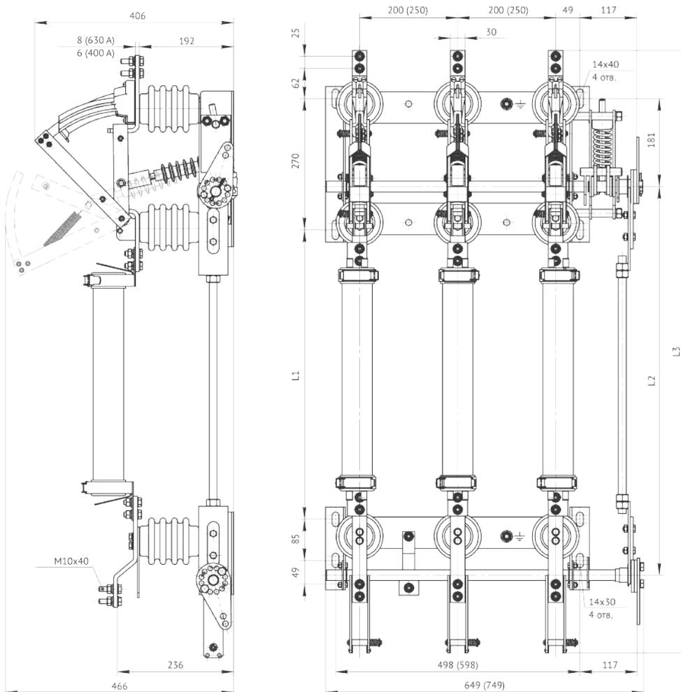
Выключатель нагрузки ВНА-10/630-Ппр-з-И2-У2
