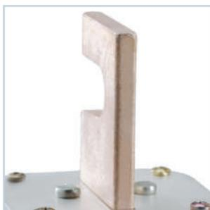
Выводы (контакты) предохранителя выполнены из электротехнической меди с гальваническим покрытием (серебрение), что обеспечивает высокие показатели токопроводности и, соответственно, экономичности и долговечности эксплуатации.
