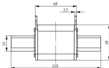
Плавкая вставка предохранителя
