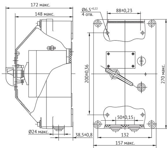
Трехполюсный автоматический выключатель с устройством блокировки в положении «Отключено»
