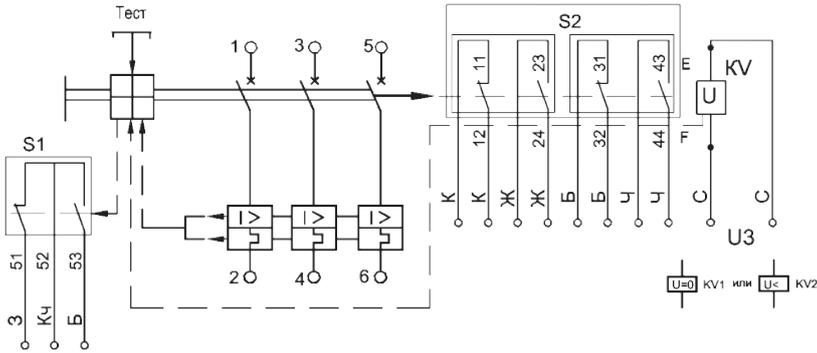
**Автоматические выключатели ВА51-39-ХХ4730 стационарного исполнения с электромагнитным приводом, независимым расцепителем, вспомогательными контактами сигнализации автоматического отключения и вспомогательными контактами**
