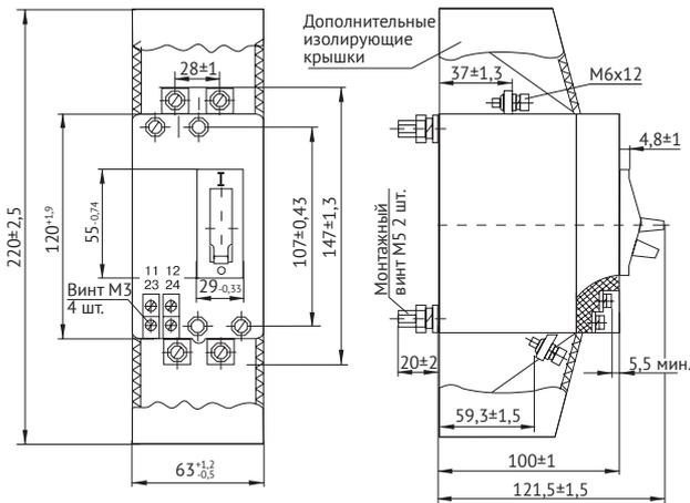
Трехполюсный автоматический выключатель ВА21
