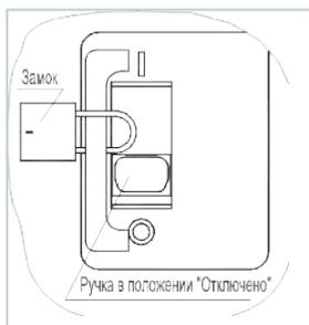
Устройство для запираания ручки стационарного автоматического выключателя в положении «Отключено» с целью обеспечения безопасности людей при ремонте и обслуживании оборудования. Является составной частью автоматического выключателя.
