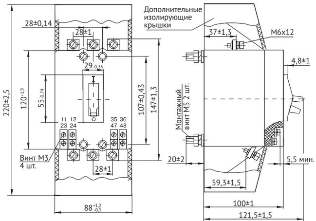
Двухполюсные и трехполюсные автоматические выключатели в дополнительной оболочке
