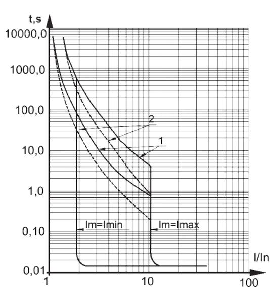
1 — зона работы теплового максимального расцепителя тока, снятая с холодного состояния
