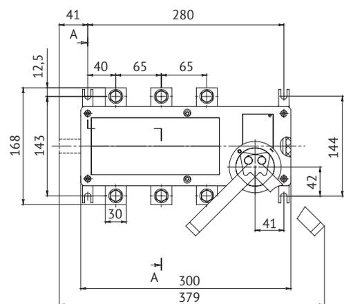
Отверстия в оболочке для установки привода аппарата на одно направление
