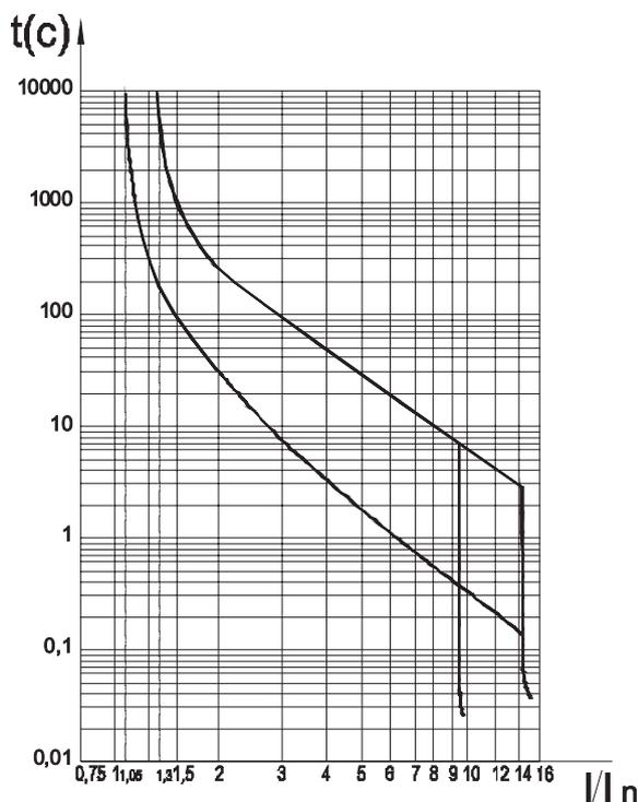
Автоматические выключатели с электромагнитными и тепловыми расцепителями с уставкой по току срабатывания  $12 I_n$  при температуре  $30^\circ\text{C}$ .
