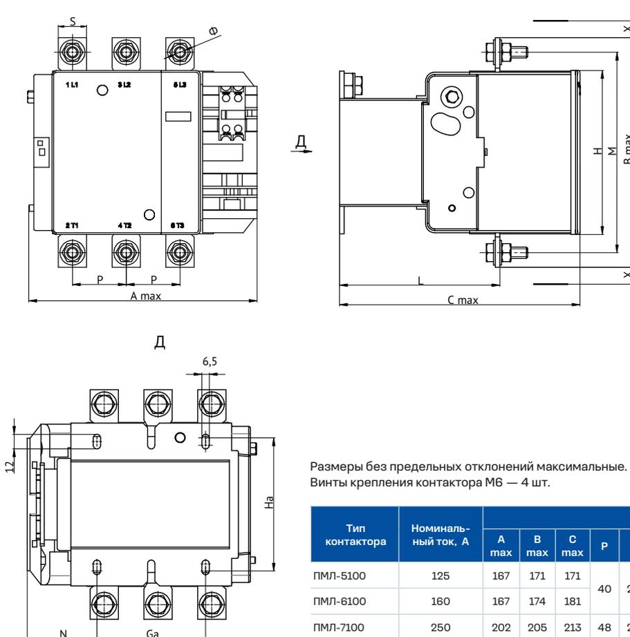
Размеры без предельных отклонений максимальные. Винты крепления контактора М6 — 4 шт.
