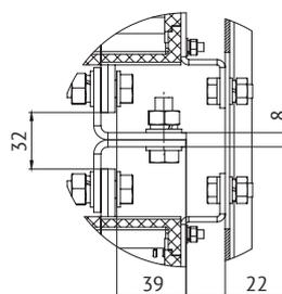
**Выключатель-разъединитель ВНК-39-31130 на одно направление**
