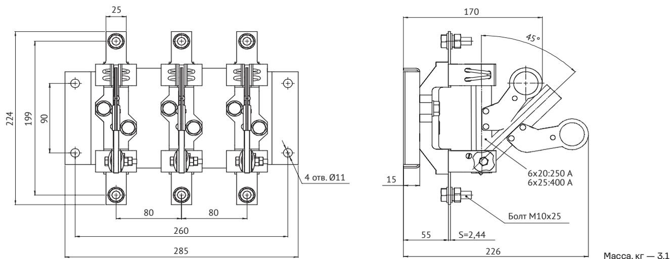
**Разъединитель РЕ19-35(37)-31120-250А(400А)-УХЛЗ трехполюсный с боковой рукояткой, переднего присоединения шин**
