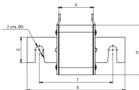
Плавкая вставка предохранителя
