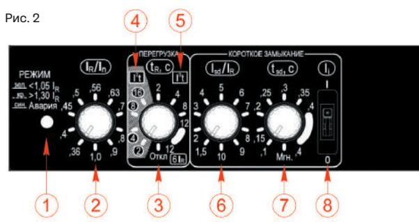
1 — индикация состояния защищаемой электрической цепи и работоспособности микропроцессорного расцепителя;
