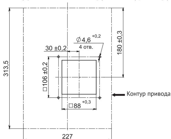
Выполнение отверстий для установки рукоятки на двери НКУ относительно контура привода.
