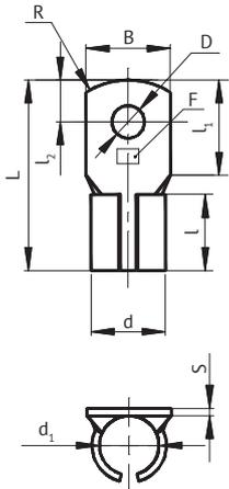
Форма и размеры присоединяемой шины
