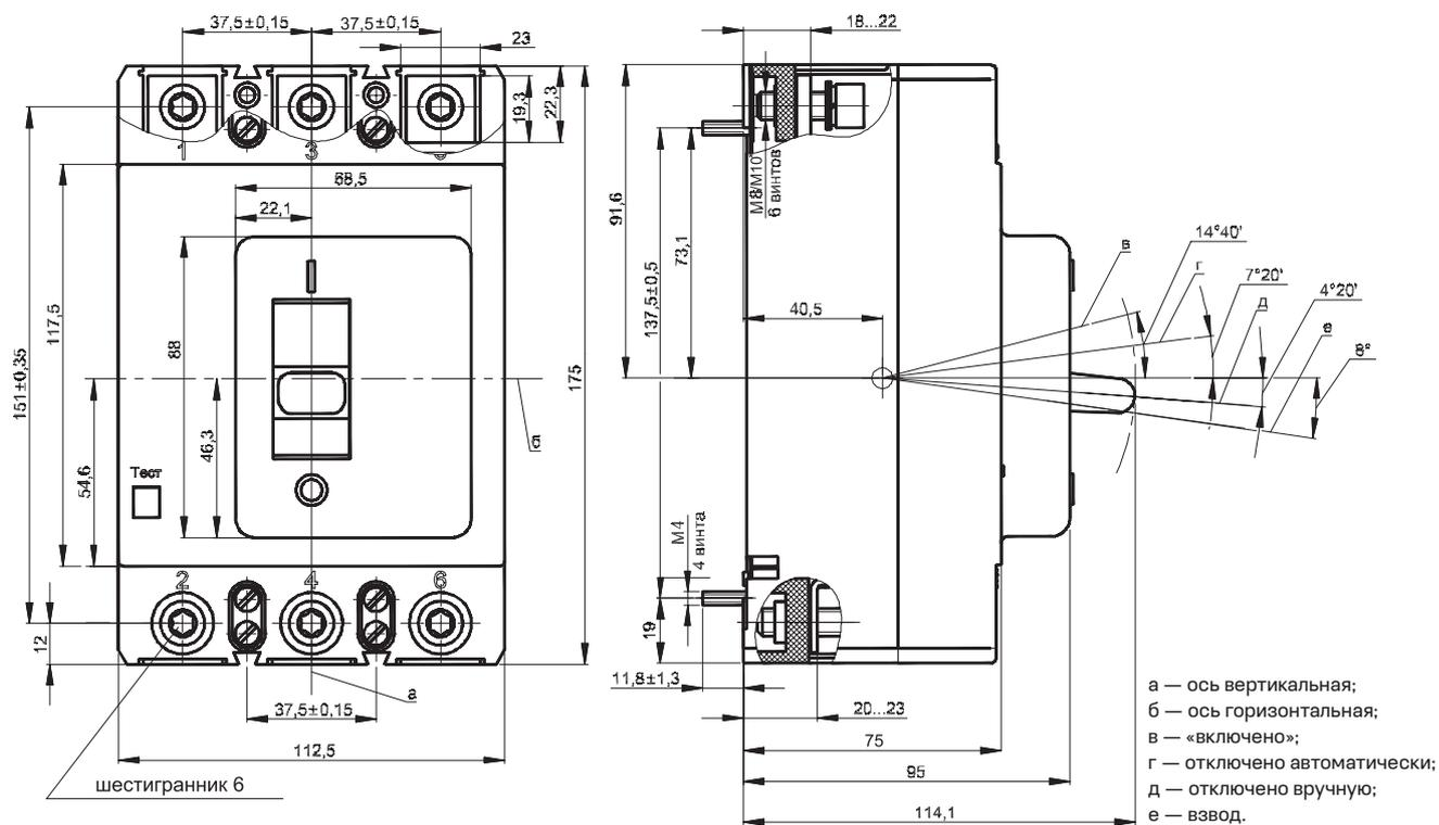
Автоматические выключатели с электромагнитным приводом
