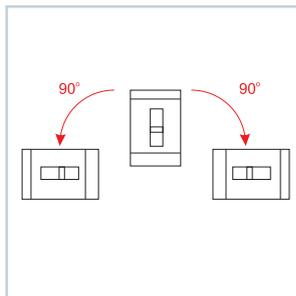
Широкие возможности по компоновке щитов за счет монтажа устройств как вертикально, так и повернув вправо/влево на 90°.
