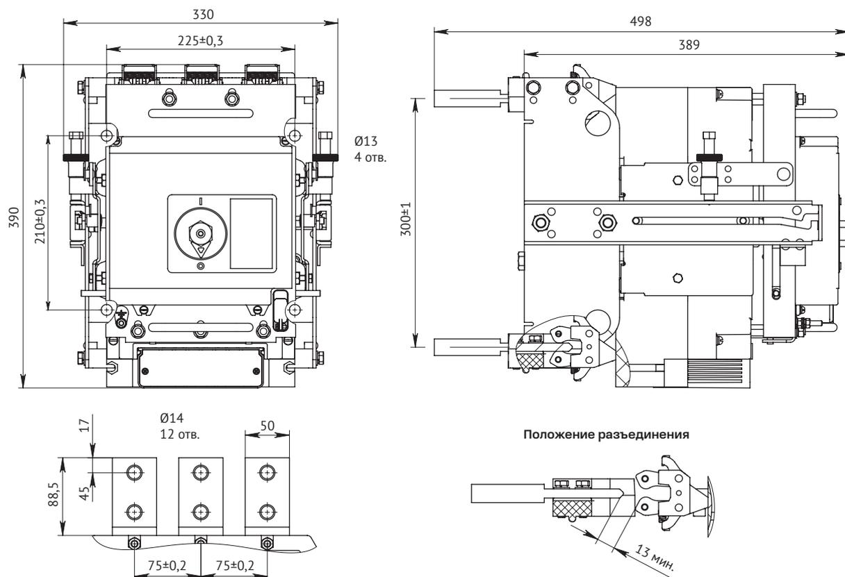
Выдвижное исполнение автоматических выключателей ВА52-41, ВА53-41, ВА55-41, ВА56-41 с ручным дистанционным приводом для управления через дверь на номинальные токи 250 А, 400 А, 630 А, 1000 А
