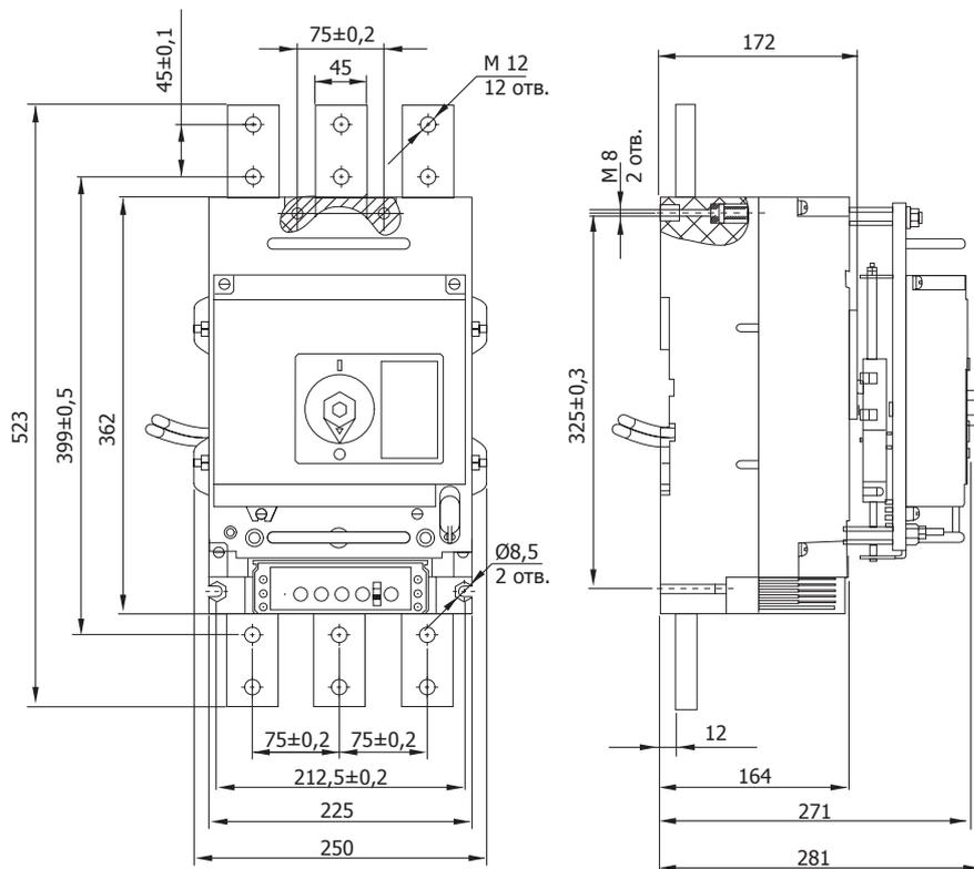
ВА52-41, ВА53-41, ВА55-41, ВА56-41 с ручным приводом заднего присоединения на номинальные токи 250 А, 400 А, 630 А, 1000 А
