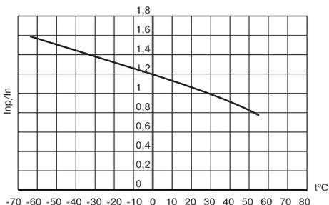
Температурные коэффициенты зависимости номинального рабочего тока автоматических выключателей серии ВА57 от температуры окружающего воздуха
