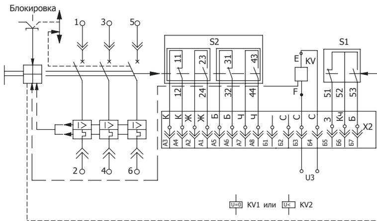
Схема электромагнитного привода
