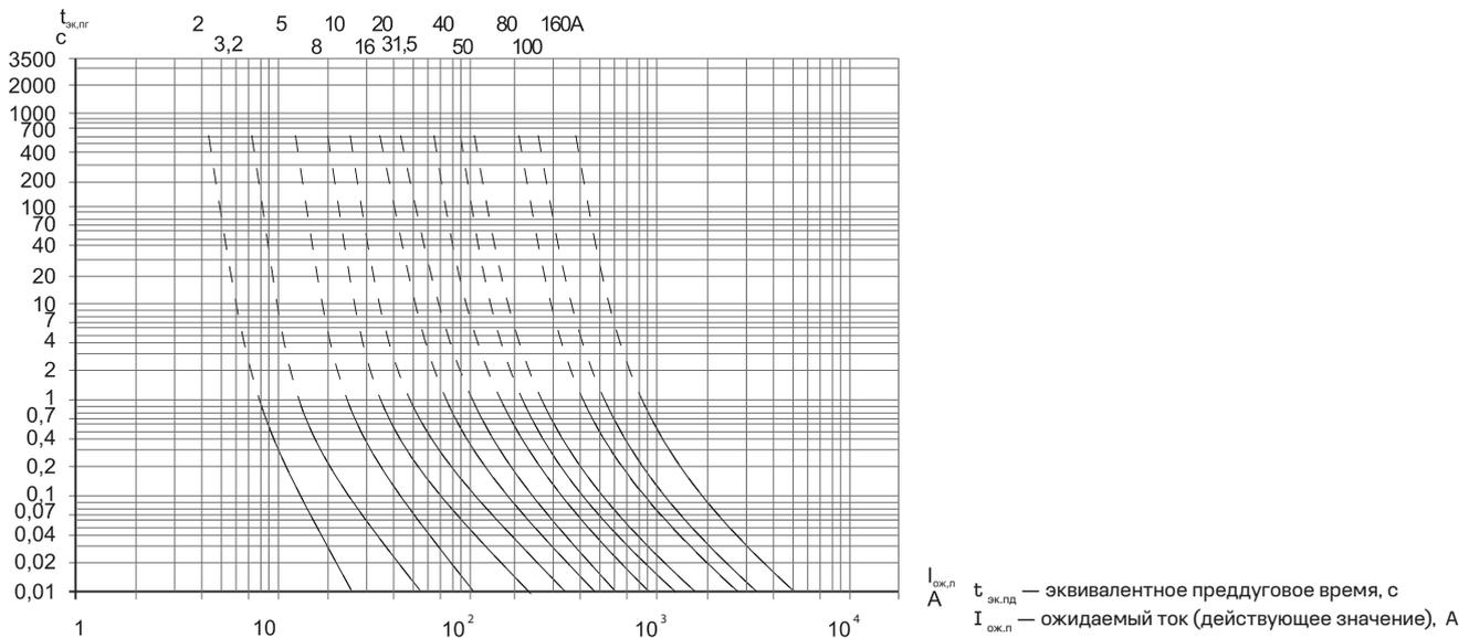
**Характеристики предельно допустимых перегрузок предохранителей на номинальные токи 2-160 А, номинальное напряжение 10 кВ**
