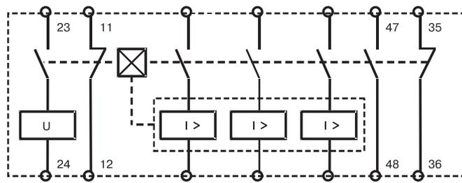
Однополюсный автоматический выключатель в трехполюсном габарите с 1 размыкающим и 1 замыкающим контактами
