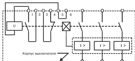
Принципиальная электрическая схема трехполюсного автоматического выключателя с независимым расцепителем и вспомогательными контактами
