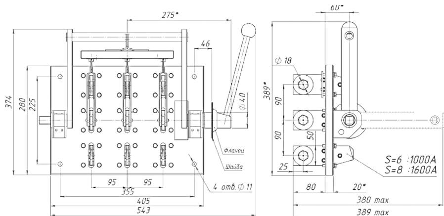
\* по заказу потребителя размер 275 мм может быть 355 мм при длине ступицы 150 мм
