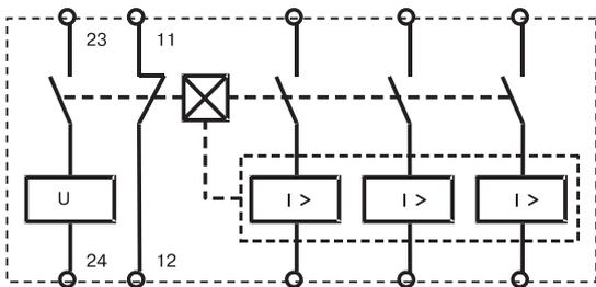
Трехполюсный автоматический выключатель с независимым расцепителем, 2 размыкающими и 1 замыкающим контактами
